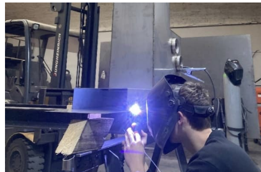
Bild 27: Schweißen des Ofens
