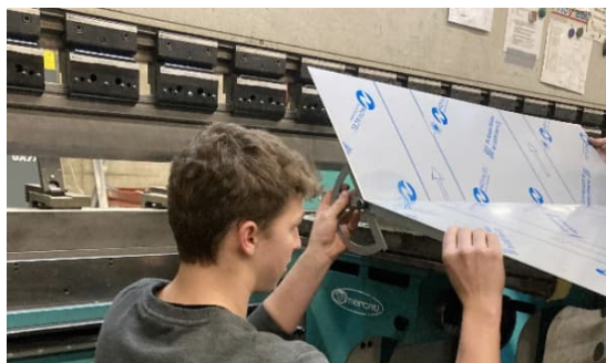
Bild 39: Abkanten der Seitenbleche mit der
