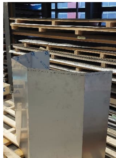
Bild 40: Fertig abgekantetes Seitenblech. Abkantwinkel 4x je 135° Abkanten der Seitenbleche mit der 4m-Abkantpresse
