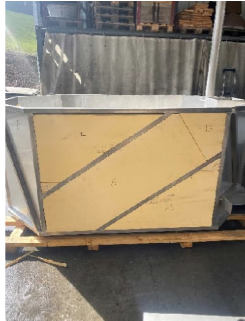
Bild 52: Boden + Seitenwände fertig isoliert
