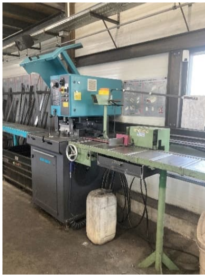
Bild 31: Zuschneiden des Chromstahl-Rohr-rahmens auf Gehrungs-Metallkreissäge mit HSS-Schneidmittel
