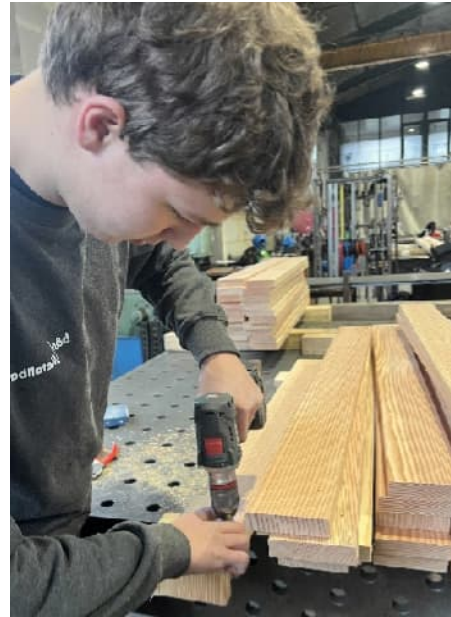
Bild 56: Auf die Unterkonstruktion werden die abgelängten und mit Traufnase versehenen vorgebohrten Douglass-Latten verschraubt
