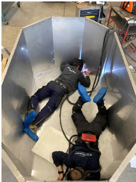
Bild 43: Verschweissen der Kehlnähte
