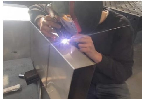
Bild 48: Verlängerung des Ascheauswurfkanals
