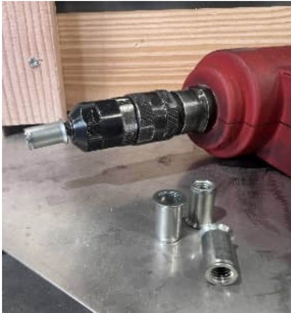
Bild 55: Um die Holz-Unterkonstruktion auf dem Chromstahlrahmen verschrauben zu können, setzen wir Blindnietmuttern ein
