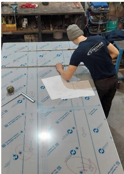
Bild 22: Abwicklung gemäss den Plänen auf die Bleche übertragen
