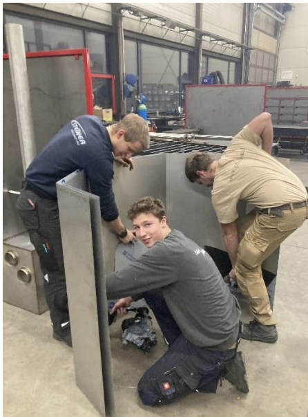
Bild 24: Schutzfolien entfernen und entfetten der Werkstücke
