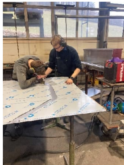
Bild 23: Zuschneiden der Bleche mit Trennscheibe und Blechscher
