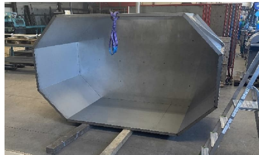
Bild 42: Einpassen der mittigen Seitenbleche welche wir auf Lichtmass zugeschnitten haben
