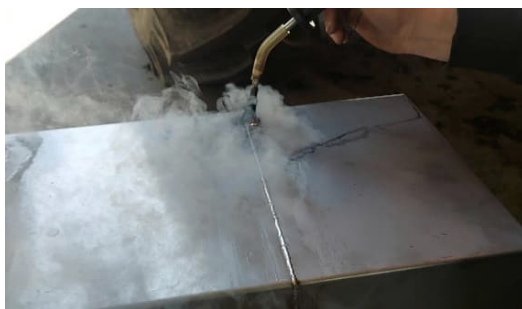
Bild 28: Absäuern der Schweissnähte um die Anlauffarbe nach dem Schweißen zu entfernen und so eine Korrosion zu verhindern.
