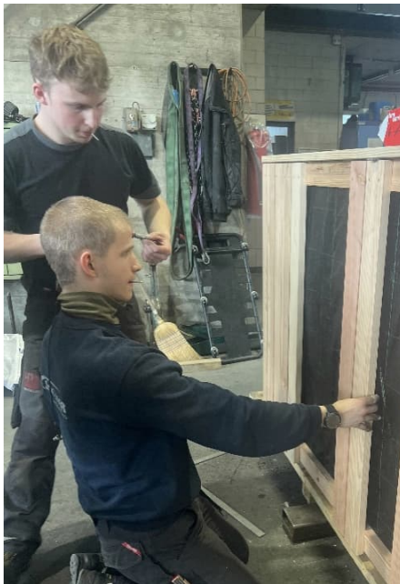
Bild 57 Einpassen und Montage der seitlichen Aussenverkleidung
