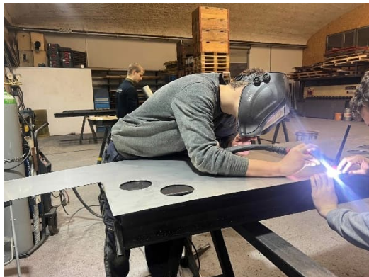
Bild 26: Zusammenheften der Werkstücke
