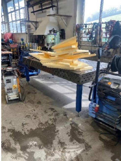
Bild 51: Isolations-Tetris nach Ausmessen und Zuschnitt
