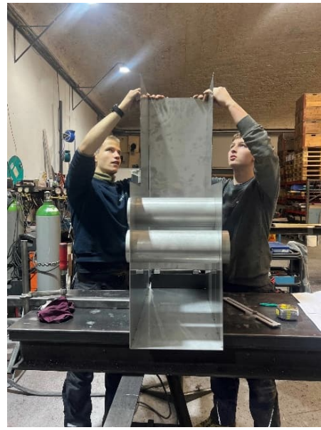
Bild 25: Aufrichten und Heften der Werkstücke
