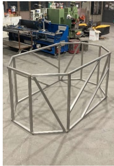
Bild 36: Fertig verschweisster Grundrahmen mit Verstrebungen zur Stabilisierung der Beckenkonstruktion
