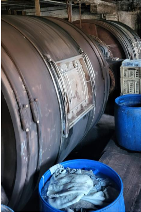
Abbildung 4 Trommel zum waschen
