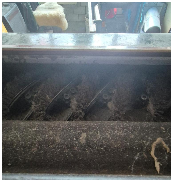
Abbildung 6 Rolle um Felle zu massieren
